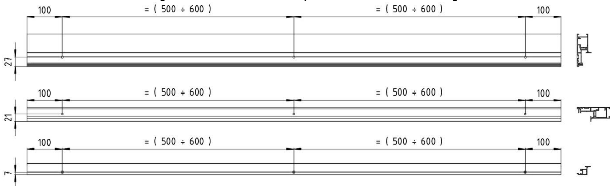
Zeichn. 9. Schema zur Ausführung der Bohrlöcher in der Führungsschiene.
